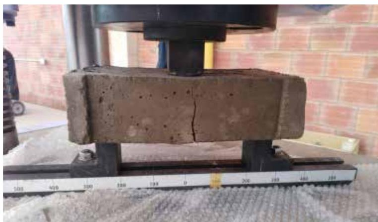
**Figura 6.** *Ensayo a flexión*
