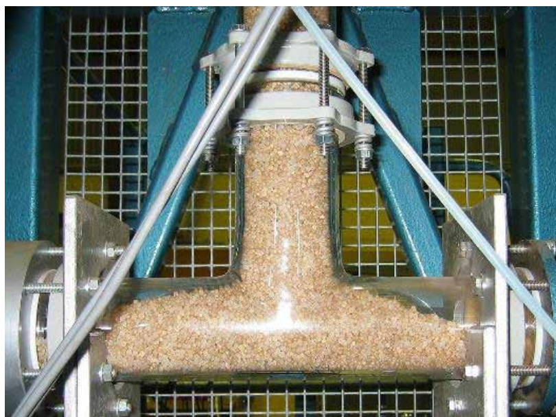
Figura 2. Sección de un sistema neumático para el transporte de sólidos.
