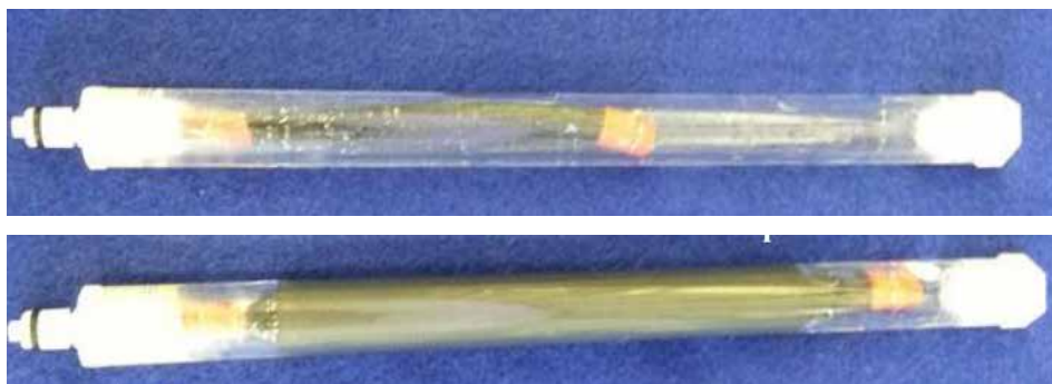
Figura 1. Acumulador de energía de tensión neumática o SEA por sus siglas en inglés.
